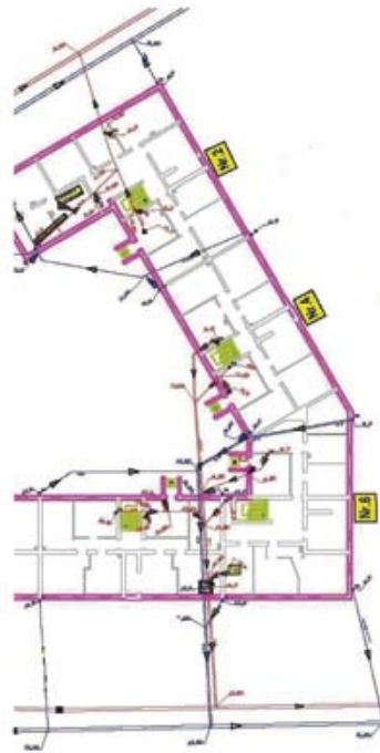
Bild 5: Grundleitungsplan nach optischer Inspektion
