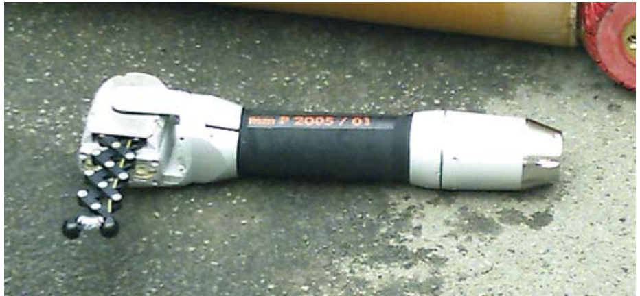
Bild 4: Satellitenkamera zur Inspektion vom Hauptkanal
