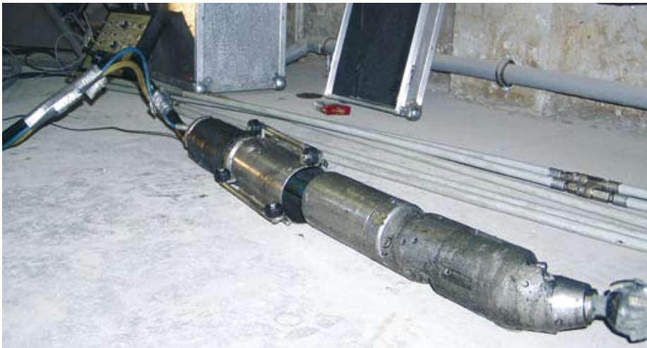
Bild 7: Fräsroboter für Grundstücksentwässerungsleitungen
